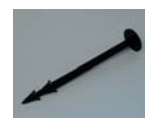
Plastspik För sammanfogning av EPS-isolering med U- och L-element, samt sammanfogning av flera skikt EPS-isolering. Åtgång ca. 4 st/m 2 grund-platta. 250 st/kartong Längd - 180 mm
